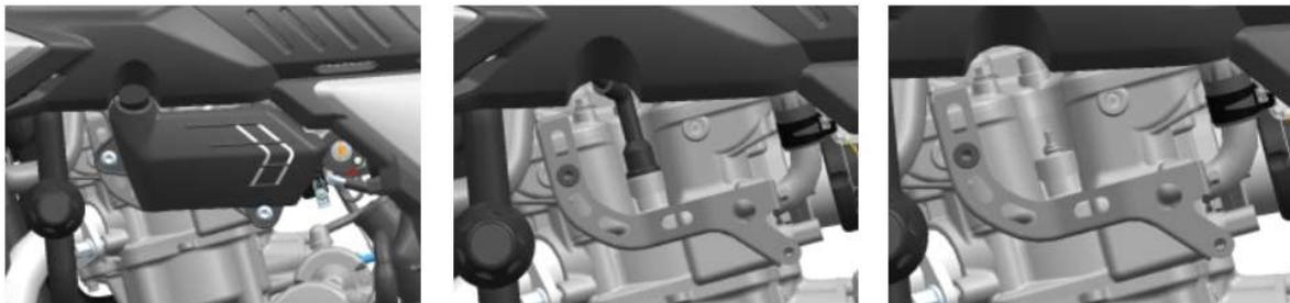
**Desmontar a vela de ignição**
