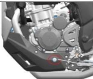
Parafuso de drenagem de óleo do motor
