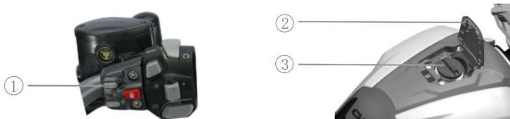
O depósito de combustível está localizado em frente à almofada do assento. Ao abrir a tampa externa do depósito de combustível, certifique-se de que o interruptor de desligar do motor está desligado e prima a tampa do depósito de combustível.
