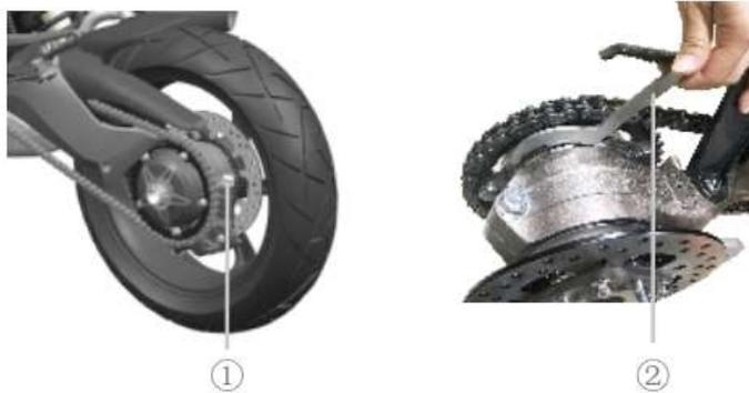
Passo 1: Solte o parafuso M16x1.5 mostrado na imagem com uma chave de binário de 100 N e o sextavado 21# externo. Tenha em atenção que não é necessário que fique completamente desparafusado.
