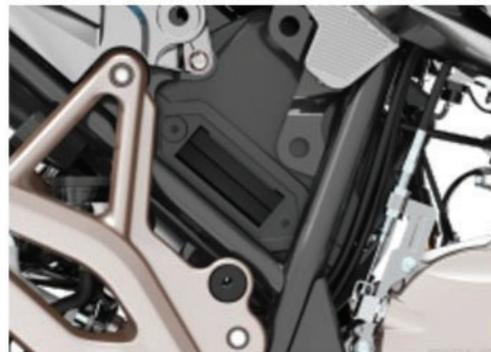
1. Remova a tampa lateral direita, irá visualizar a caixa do filtro.
