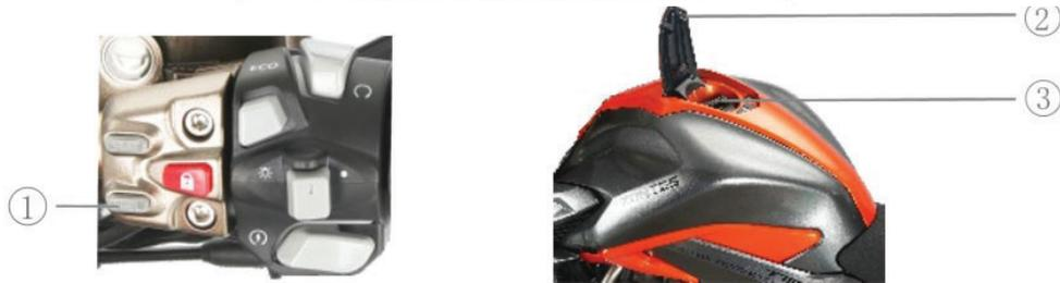
O depósito de combustível está localizado no interior dos plásticos na parte da frente do banco. Quando abre a tampa do depósito, confirme que o botão corta corrente está desligado, pressione o botão "FUEL" (1), e a tampa do depósito irá abrir (2), rode o tampão do depósito (3) no sentido contrário aos ponteiros do relógio. Para colocar o tampão faça ao contrário.
