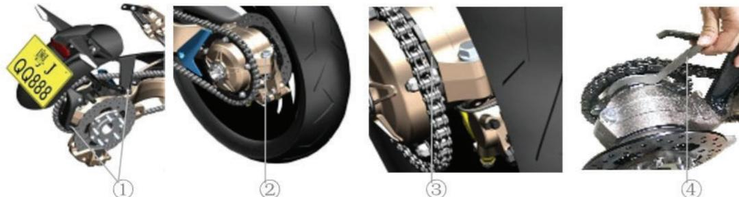
Passo1: Use uma chave n6 para remover o parafuso M8 que mostra na figura, cuidadosamente retire o guarda lamas, com cuidado para não puxar os fios.
