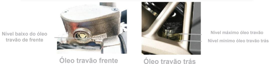
Verifique a posição do nível óleo dos travões tanto no da frente como no de trás. Se o nível do líquido estiver abaixo (low) da marca, verifique o desgaste das pastilhas e fugas.
