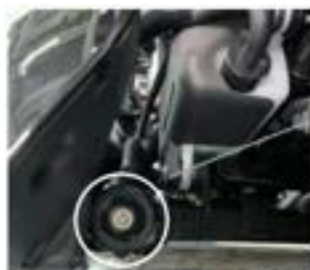
Tampa do depósito de água
